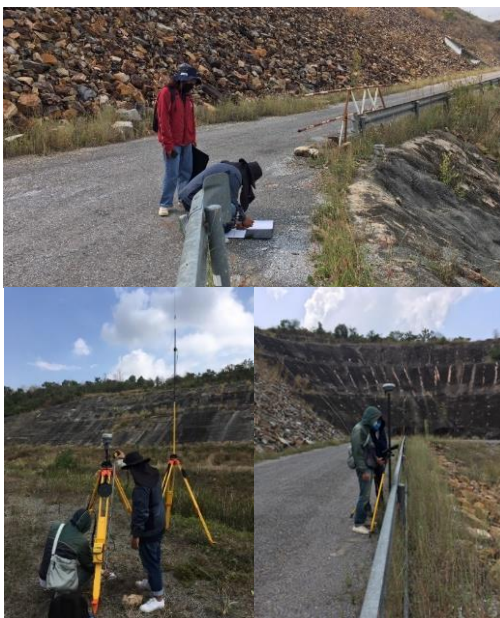
รูปที่ 5 การวางเป้าสำหรับจุดควบคุมภาคพื้นดิน (GCP) และการสำรวจรังวัดด้วยดาวเทียม GNSS แบบวิธี RTK
