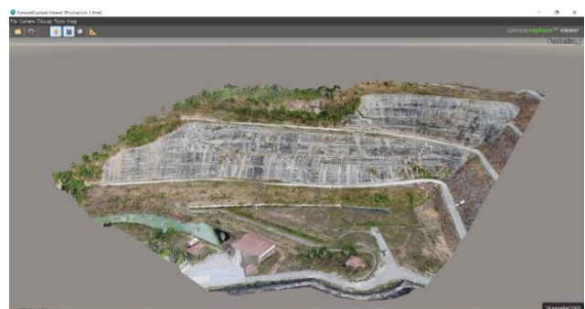
รูปที่ 6 ผลลัพธ์แบบจำลองสามมิติของงานป้องกันทางลาดไหล่เขาในพื้นที่ศึกษา
