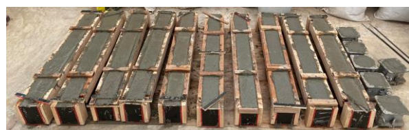
รูปที่ 4 คานคอนกรีตเสริมเหล็กที่ใช้ในการศึกษา
