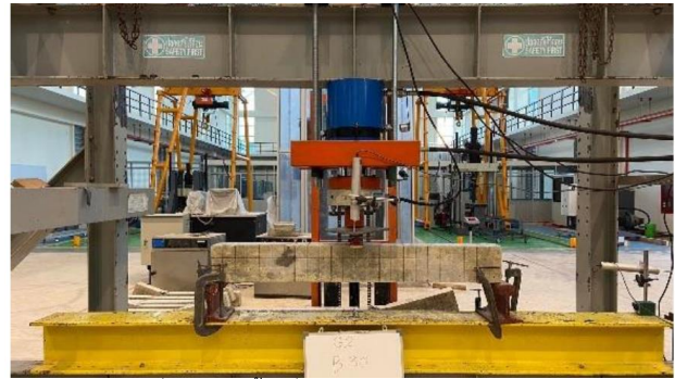
รูปที่ 7 การติดตั้งเครื่องมือทดสอบในห้องปฏิบัติการ (สำหรับการทดสอบแบบ 3 จุด)
