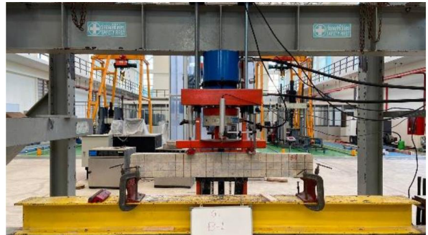
รูปที่ 8 การติดตั้งเครื่องมือทดสอบในห้องปฏิบัติการ (สำหรับการทดสอบแบบ 4 จุด)
