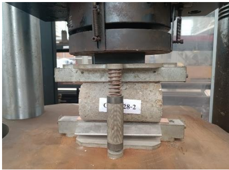
รูปที่ 6 การทดสอบกำลังดึงแบบผ่าซีก
