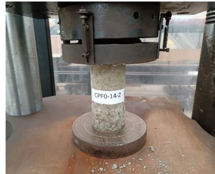
รูปที่ 4 การทดสอบกำลังอัด
