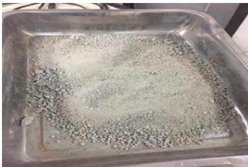
รูปที่ 1 เศษคอนกรีตจากโครงการก่อสร้างทางแยกต่างระดับ (แยกดงอู่ผึ้ง) จ.อุบลราชธานี
