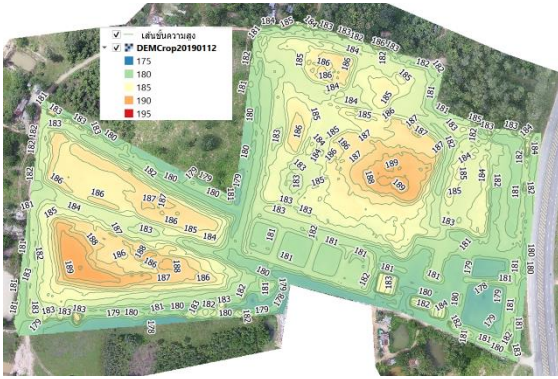
รูปที่ 3 เส้นชั้นความสูงของบ่อขยะมูลฝอยวันที่ วันที่ 12 มกราคม 2563
