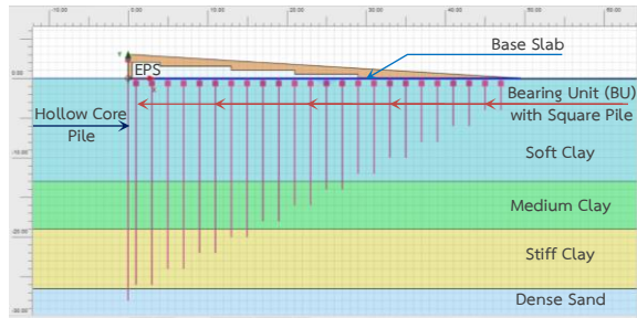
2) เชิงลาดคั่นทางคอสพานที่มีวัสดุ EPS
