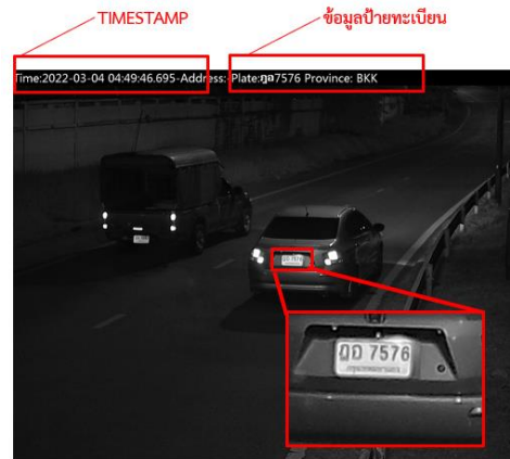
รูปที่ 3 ตัวอย่างภาพจากระบบการอ่านป้ายทะเบียนอัตโนมัติ
