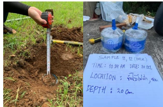
รูปที่ 4 ท่อที่ถูกกดลงในชั้นหน้าดินและตัวอย่างที่เก็บแล้วพร้อมนำกลับไปทดสอบ
