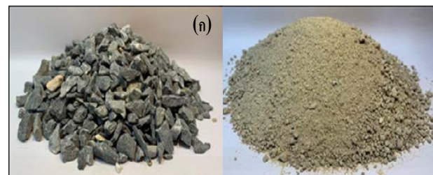
รูปที่ 1 (ก) หิน และ (ข) ทรายปนทรายแป้ง ที่ใช้ในการทดสอบ
