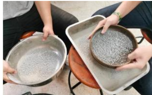
รูปที่ 3 เศษคอนกรีต
