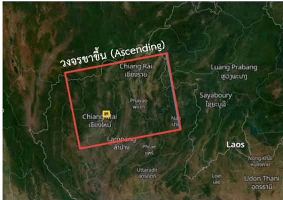
รูปที่ 6 ภาพ SAR ที่นำไปประมวลผลและทิศทางการเคลื่อนที่ของดาวเทียม Sentinel-1
