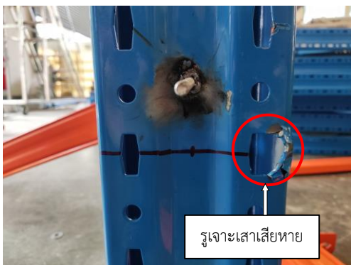
รูปที่ 16 ลักษณะการวิบัติที่รูเจาะเสาของตัวอย่าง 2.75U-110B-1B-M
