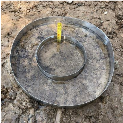
รูปที่ 13 ทดลองวัดการซึมผ่านของน้ำผ่านผิวดินโดยวิธี Double ring
