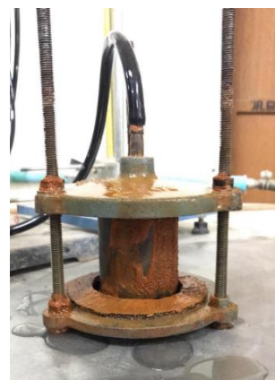
รูปที่ 16 ตัวอย่างอุปกรณ์ในการทดสอบหาค่า k โดยวิธี falling head
