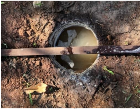
รูปที่ 17 ทดลองวัดการซึมผ่านของน้ำโดยวิธี Inversed Auger-hole
