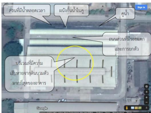
รูปที่ 3 ตำแหน่งของคูน้ำเทียบกับอาคารที่เกิดความเสียหาย
