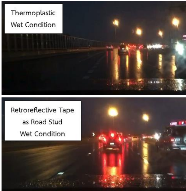
รูปที่ 9 เปรียบเทียบก่อนและหลังติดตั้งเทปเส้นจราจรสะท้อนแสง แทนหลอดสะท้อนแสง ในสภาวะเปียก
