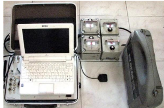
รูปที่ 12 ชุดเครื่องมือสำหรับการตรวจวัดแบบ Ambient vibration
