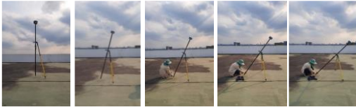
รูปที่ 9 การรังวัดขณะเอียงเสาบนลาดฟ้า 0°, 15°, 25°, 35° และ 45° (รูปเรียงจากซ้ายไปขวาตามลำดับ)
