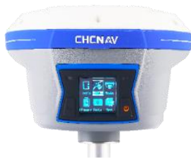
รูปที่ 2 เครื่องรับสัญญาณดาวเทียมยี่ห้อ CHC รุ่น i90
