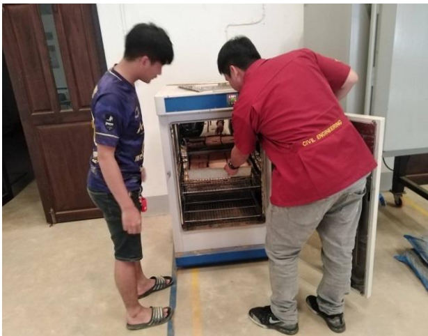
รูปที่ 4 กระบวนการอบอิฐโดยใช้เตาอบไฟฟ้า
