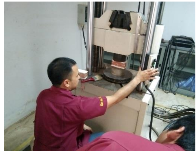
รูปที่ 5 การทดสอบการต้านทานกำลังอัดของอิฐโดยเครื่อง UTM
