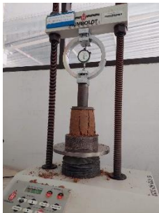
รูปที่ 6 การทดสอบแรงอัดแบบไม่ถูกจำกัด
