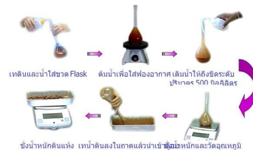
รูปที่ 3 ขั้นตอนทดสอบหาค่าความถ่วงจำเพาะของดิน [10]
