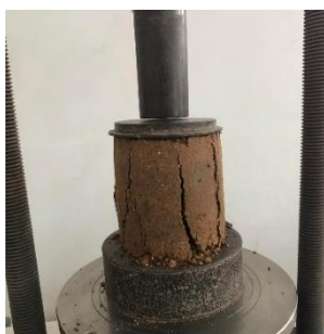
รูปที่ 10 การวิบัติของก้อนตัวอย่างของดินลูกรังที่ผสมกากเคลเซียมคาร์ไบด์
