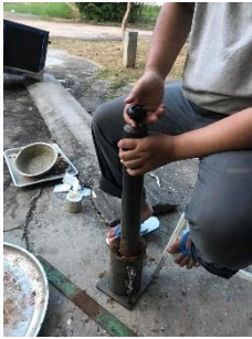
รูปที่ 5 การทดสอบการบดอัดดิน
