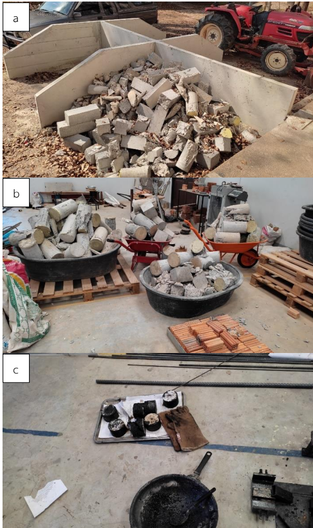
รูปที่ 2 การแยกและการพักวางของเสียจากการทดสอบวัสดุก่อสร้าง
