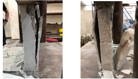
รูปที่ 5 การวิบัติของผนังด้านข้าง CT
