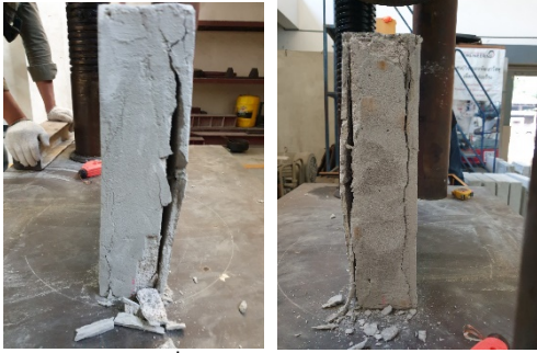
รูปที่ 10 การวิบัติของผนังด้านข้าง XS32-S
