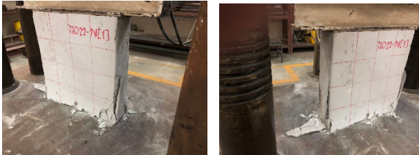
รูปที่ 12 การวิบัติของผนังด้านข้าง No22-BN
