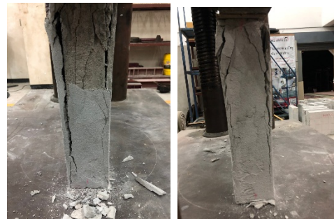
รูปที่ 9 การวิบัติของผนังด้านข้าง XS31-S
