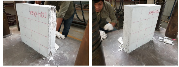
รูปที่ 15 การวิบัติของผนังด้านข้าง XS32-BN
