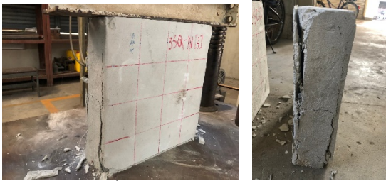
รูปที่ 11 การวิบัติของผนังด้านข้าง SM-BN
