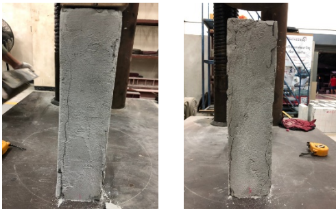
รูปที่ 13 การวิบัติของผนังด้านข้าง No23-BN
