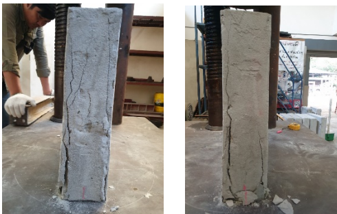
รูปที่ 14 การวิบัติของผนังด้านข้าง XS31-BN
