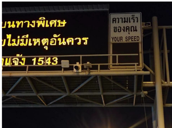
รูปที่ 3 การติดตั้งกล้อง ALPR บนโครงข่ายพร้อมช่องจราจร (Gantry)
