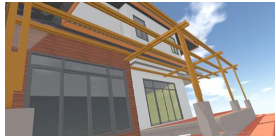
รูปที่ 16 การตรวจสอบแบบจำลองโดยใช้เทคโนโลยี Virtual reality (VR) พบว่าการวางแปโดยไม่มีความยึดกับผนัง
