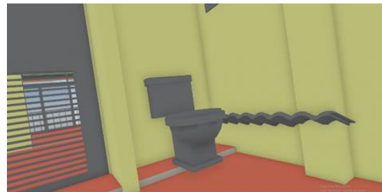
รูปที่ 17 การตรวจสอบแบบจำลองโดยใช้เทคโนโลยี Virtual reality (VR) พบว่ากระเบื้องหลังคาทะลุผนังเข้ามาภายในบ้าน
