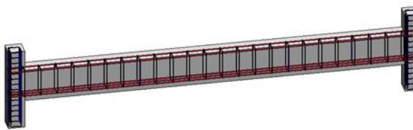
รูปที่ 9 รูปตัดใส่เหล็กพื้น
