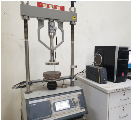
รูปที่ 2 เครื่องทดสอบกำลังรับแรงอัดแกนเดี่ยว
