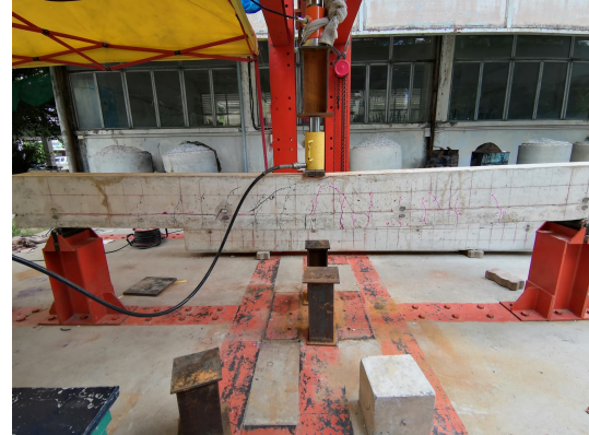
รูปที่ 7 การวิบัติของคานทดสอบ
