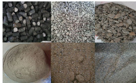
รูปที่ 1 รูปวัสดุที่ใช้ในการทดสอบเรียง(จากซ้ายไปขวา) เหล็กข้อย่อย-แบไรต์-หินปูน เถ้าลอย-ทราย-เศษหินแกรนิต
