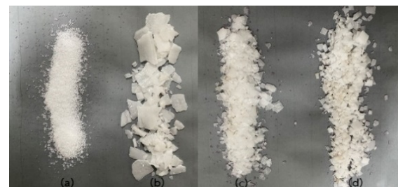
รูปที่ 1 โซเดียมไฮดรอกไซด์ชนิดห้องปฏิบัติการและชนิด อุตสาหกรรมแบรนด์ RCI (a), AGC (b), China (c), Taiwan (d)
