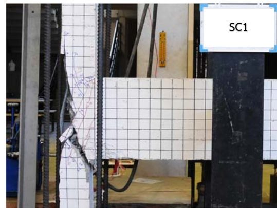
รูปที่ 12 ความเสียหายของตัวอย่าง SC1 หลังการทดสอบ
