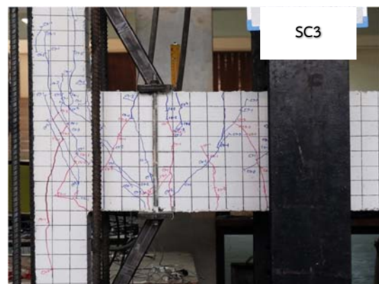
รูปที่ 16 ความเสียหายของตัวอย่าง SC3 หลังการทดสอบ
