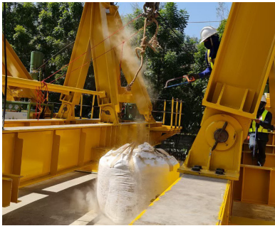
รูปที่ 6 การทดสอบเชิงพลวัตด้วยการกระแทกด้วยถุงทราย
