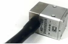
รูปที่ 16 อุปกรณ์ตรวจจับความเร่ง (Kyowa)
