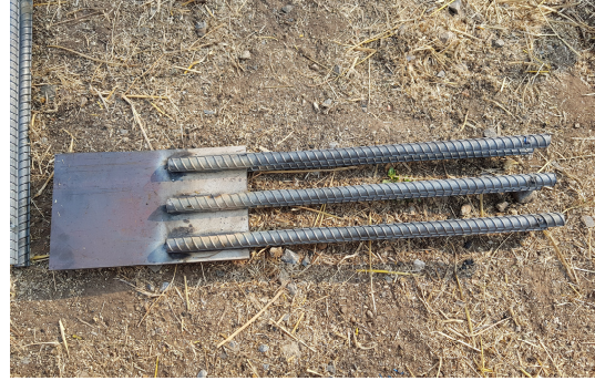
รูปที่ 1 เหล็กข้ออ้อยที่เชื่อมติดกับแผ่นเหล็กที่ใช้ในงานวิจัย
