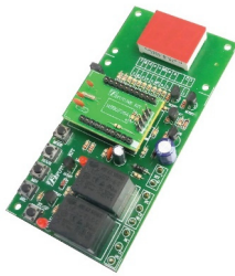
รูปที่ 4. แผงวงจรควบคุมเวลา
