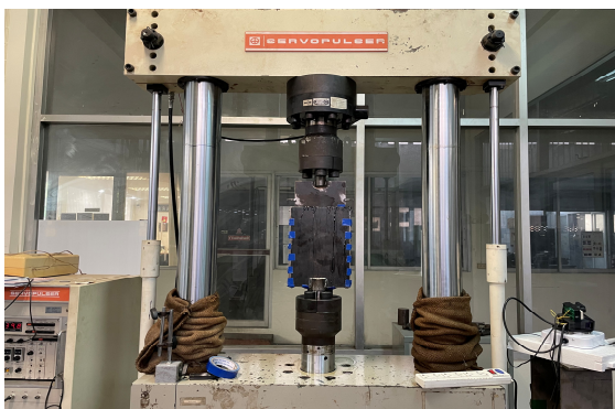
รูปที่ 6 เครื่องทดสอบแบบวิสจักรขนาด 20 ตัน (Servopulser)
