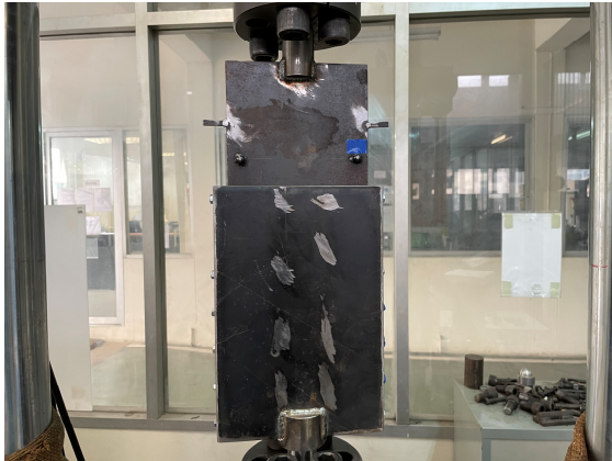
รูปที่ 5 ภาพถ่ายผนังสลายพลังงานแบบวิสโคอีลาสติคย่อยส่วน
