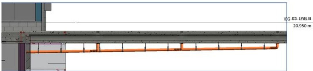
รูปที่ 6 ตัวอย่างท่อน้ำเสียเมื่อมีการใส่ตัวแขวนและค้ำท่อ
