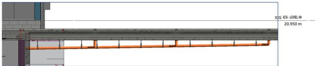
รูปที่ 8 ท่อน้ำเสียมีการใส่แคลมป์แขวนท่อและการค้ำท่อ (จากการประยุกต์ใช้โปรแกรมไดนาโม)
