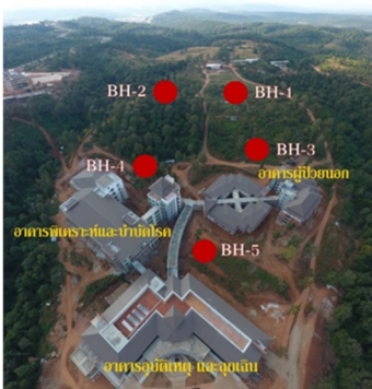
รูปที่ 1 ภาพถ่ายมุมสูงของอาคารพิเคราะห์โรคและข้อมูลดิน 5 หลุม
