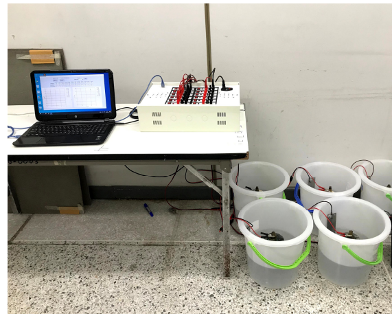
(ก) อุปกรณ์การทดสอบการเกิดสนิมของเหล็กเสริมในคอนกรีตโดยวิธีการเร่งด้วยไฟฟ้า
