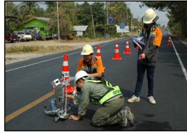
รูปที่ 5 เครื่องทดสอบค่าความต้านทานการลื่นไถล British Pendulum Tester
