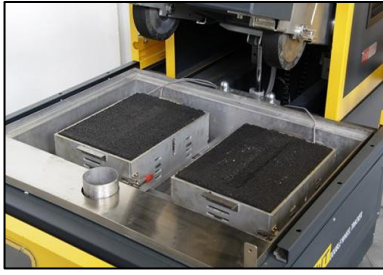
รูปที่ 3 การทดสอบความต้านทานการเกิดร่องล้อ
