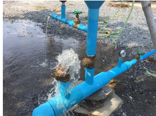
รูปที่ 5 การสูบน้ำโดยเครื่องตะบันน้ำที่ใช้วาล์วตามแบบของ สวทช
