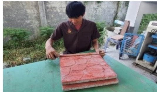
รูปที่ 10 ทดสอบลักษณะทั่วไปและมิติของผลิตภัณฑ์กระเบื้องซีเมนต์ปูพื้นพิมพ์ลายจากฝุ่นหินแกรนิต [4]
