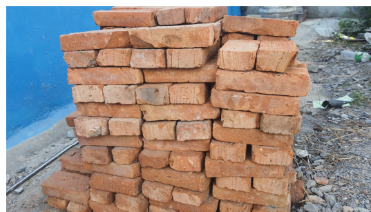
รูปที่ 5 ลักษณะของผลิตภัณฑ์อิฐมอดูตินเหนียวผสมเส้นใยผักตบชวาแห้งบดละเอียด [2]
