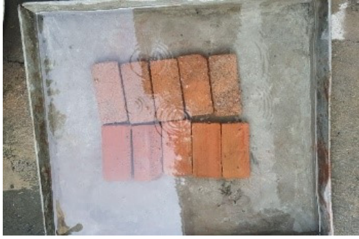
รูปที่ 6 ทดสอบการดูดซึมน้ำของอิฐมอญดินเหนียวผสมเส้นใยผักตบชวาแห้งบดละเอียด [2]
