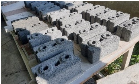
รูปที่ 7 ลักษณะของผลิตภัณฑ์อิฐบล็อกประสานจากฝุ่นหินแกรนิต [3]
