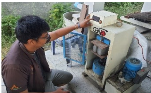
รูปที่ 8 ทดสอบการกำลังรับแรงอัดของผลิตภัณฑ์อิฐบล็อกประสานจากฝุ่นหินแกรนิต [3]
