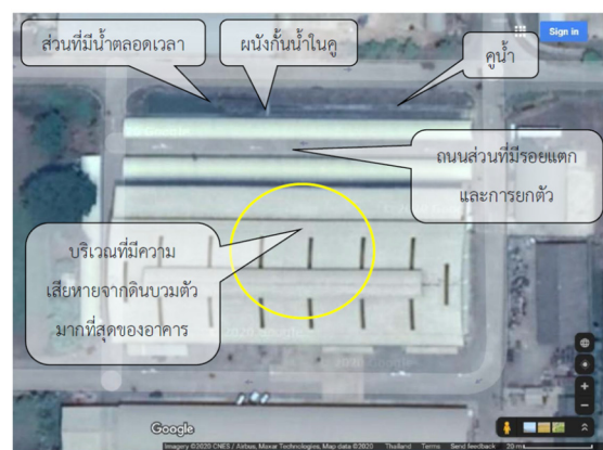
รูปที่ 15 ตำแหน่งของคูน้ำเทียบกับอาคารที่เกิดความเสียหาย
