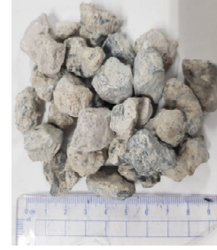
ค) มวลรวมหยาบจากการรีไซเคิลคอนกรีตผลิตนำเข้าจากโรงงานในประเทศญี่ปุ่น (กลุ่ม RP)
