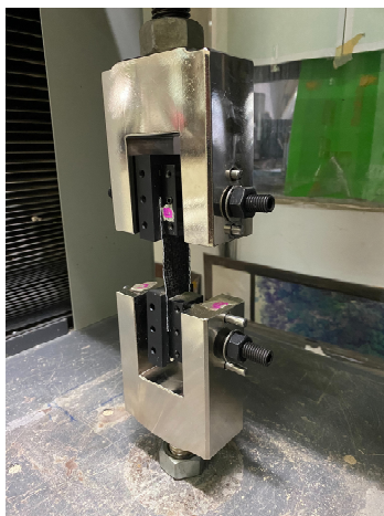
รูปที่ 4 การทดสอบหาค่ากำลังรับแรงดึง
