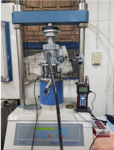
รูปที่ 3 ชุดเครื่องมือการทดสอบแรงกดสามแกนและการทดสอบการคืบของดินเหนียว
