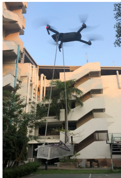
รูปที่ 1 รูปภาพแสดงโดรนที่ติดตั้งอุปกรณ์วัดปริมาณฝุ่นละออง อุปกรณ์วัดอุณหภูมิและความชื้น และอุปกรณ์กำหนดตำแหน่งบนพื้นโลก (GPS)
