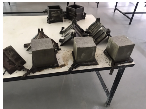
รูปที่ 2 ตัวอย่างเป็นลูกบาศก์ขนาด 15 ซม. x 15 ซม. x 15 ซม.
