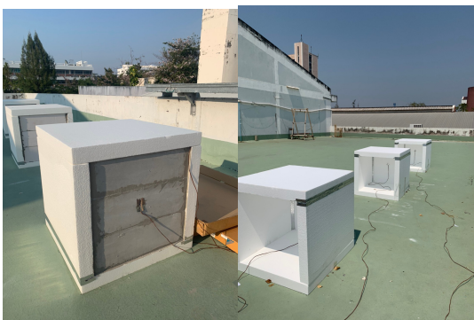
รูปที่ 5 โมเดล: การทดสอบความสามารถในการกระจายความร้อน
