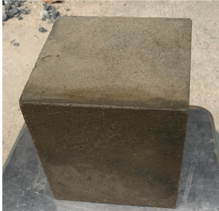
รูปที่ 3 ตัวอย่างระบุงเป็นลูกบาศก์ขนาด 15 ซม. x 15 ซม. x 15 ซม.
