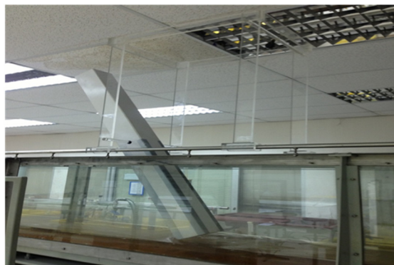
รูปที่ 7 การไหลของน้ำในรางน้ำเปิดเข้ากระทบกับวัตถุ
