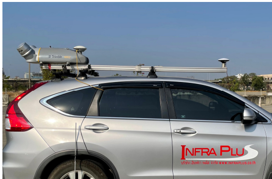
รูปที่ 4 การติดตั้งอุปกรณ์บนรถหลังการถยนต์เพื่อทำการวิ่งวัดแบบจลน์
