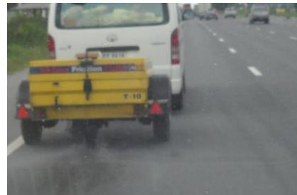
รูปที่ 5 ตัวอย่างตำแหน่งทดสอบด้วยเครื่องมือทดสอบ Skid (ASFT T-10)
