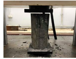
รูปที่ 5 ลักษณะการวิบัติของตัวอย่างทดสอบคอนกรีตล้วน
