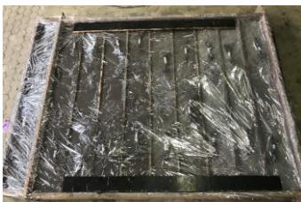
(ข) การบ่มคอนกรีต
