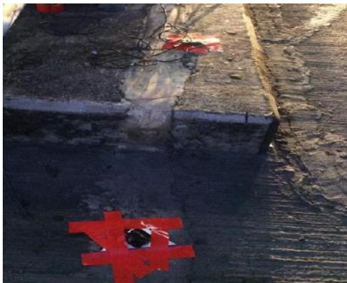
รูปที่ 5 ตำแหน่งตรวจวัดค่าความเร่งการสั่นสะเทือนที่ผิวทางและบนฐานรองรับคอนกรีตของตู้รับชำระค่าผ่านทาง
