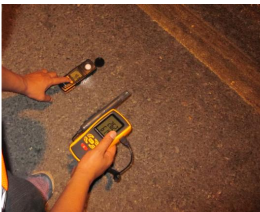
รูปที่ 6 ชุดเครื่องวัดค่าความส่องสว่างของแสงไฟ (Lux) และเครื่องวัดค่าอุณหภูมิในสภาพแวดล้อมและความชื้นสัมพัทธ์ในอากาศ
