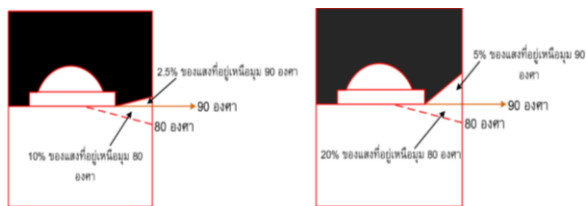
รูปที่ 6 การกระจายแสงแบบ Cut off และแบบ Semi-Cut off (Illuminating Engineering Society)
